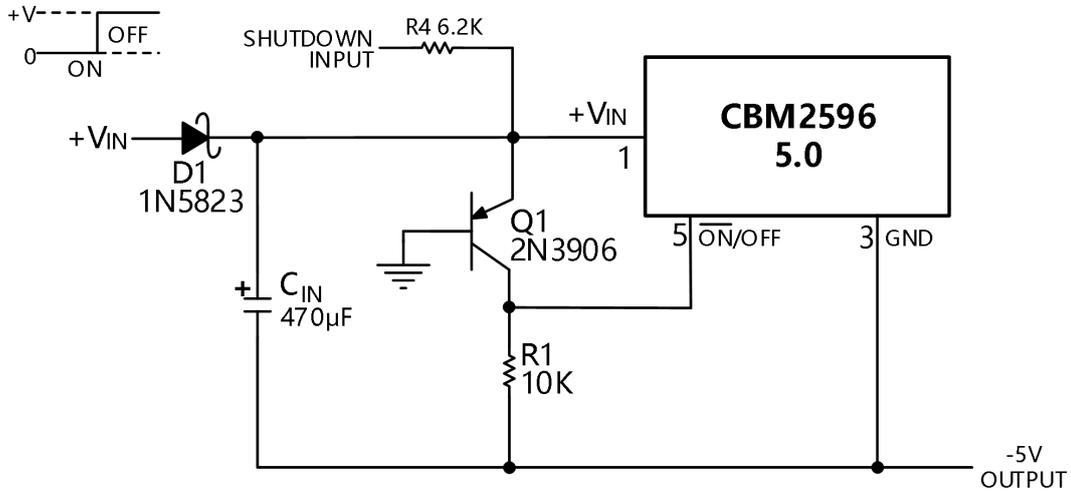
图 9. 逆变调节器接地参考关停
