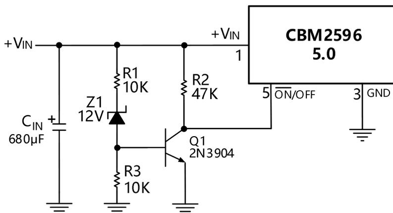
图 4. 降压调节器欠压锁定
