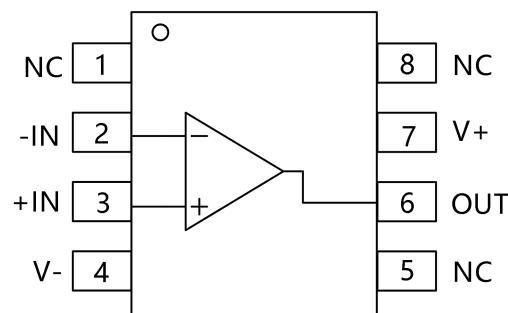
SOIC-8(SOP8) , MSOP-8
