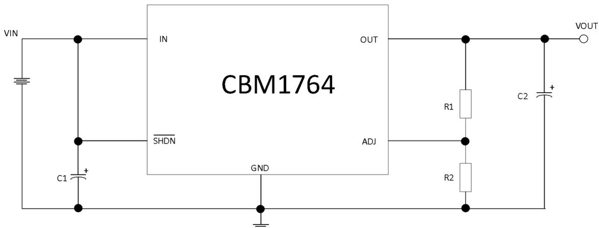
$C1=C2=10\mu\text{F}$  TANTALUM CERAMIC OR ALUMINUM ELECTROLYTIC
