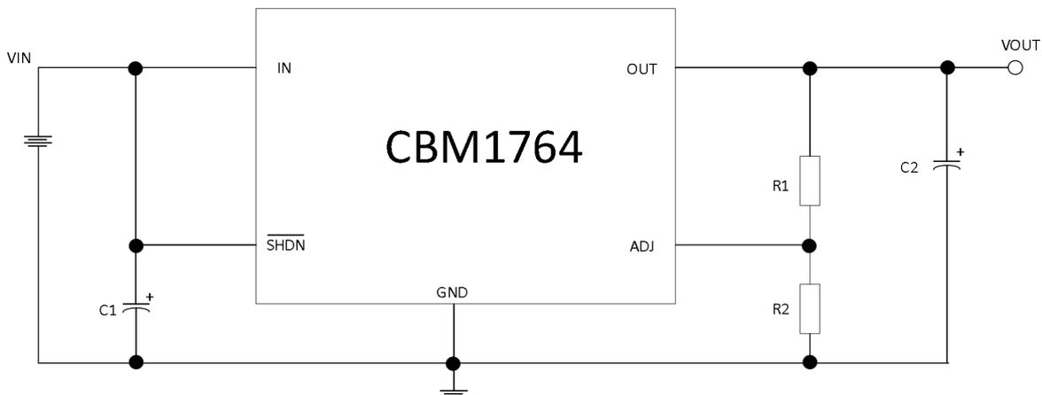
$C1=C2=10\mu\text{F}$  TANTALUM CERAMIC OR ALUMINUM ELECTROLYTIC
