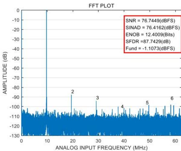
图 7.单音 32K( $f_{IN}=10\text{MHz}$ ,  $f_S=125\text{MSPS}$ )
