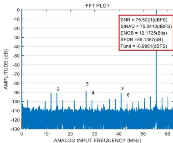
图 8.单音 32K( $f_{IN}=70\text{MHz}$ ,  $f_S=125\text{MSPS}$ )
