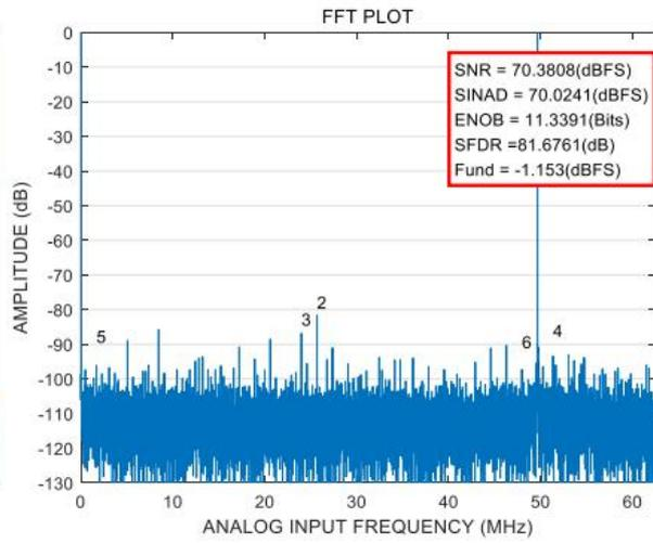
图 10.单音 32K( $f_{IN}=200\text{MHz}$ ,  $f_S=125\text{MSPS}$ )
