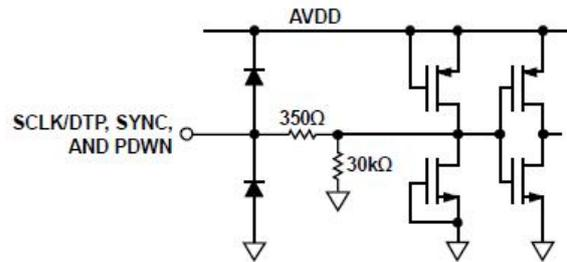
图 12. 等效 SCLK/DTP, SYNC, 和 PDWN 输入电路
