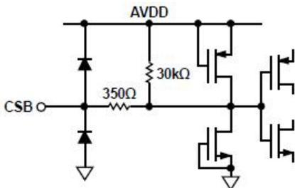
图 13. 等效 CS 输入电路
