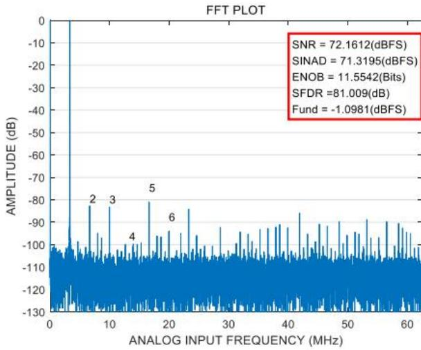
图9.单音 32K( $f_{IN}=128\text{MHz}$ ,  $f_S=125\text{MSPS}$ )
